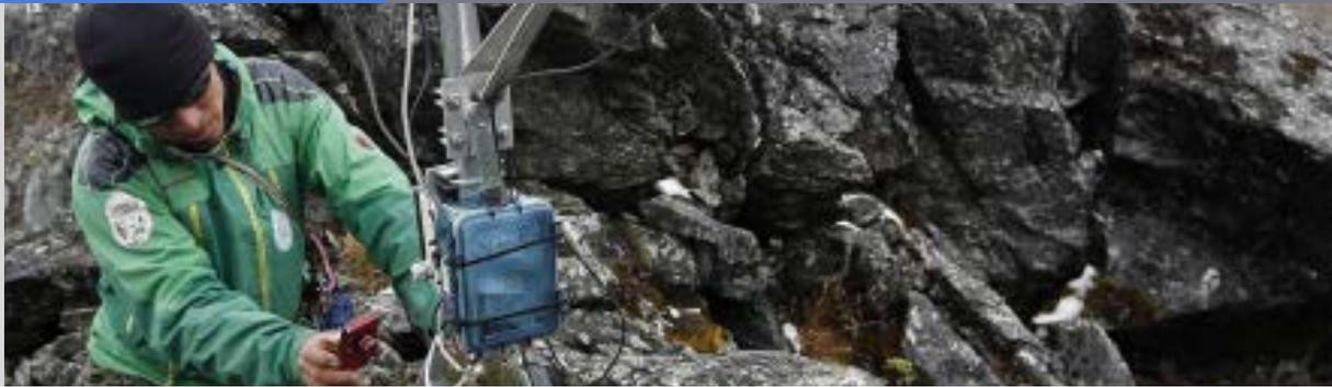
El HOBO RX3000 es una Estación Meteorológica que combina una mayor flexibilidad y la medición en una pantalla LCD, dentro de una estructura resistente, fácil de implementar.
