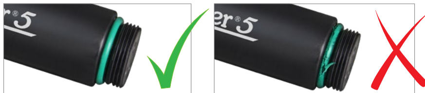
Figura 10-25 Junta tórica del Levelogger dañada
