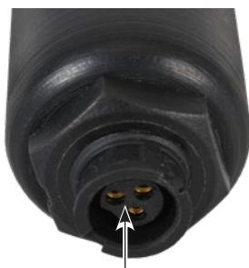
Conector del pluviómetro
