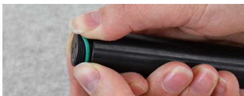
Figura 10-26 Reemplazo de las juntas tóricas dañadas del Levelogger
