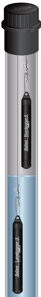
Figura 10-18 Levelogger y Barologger en el pozo
