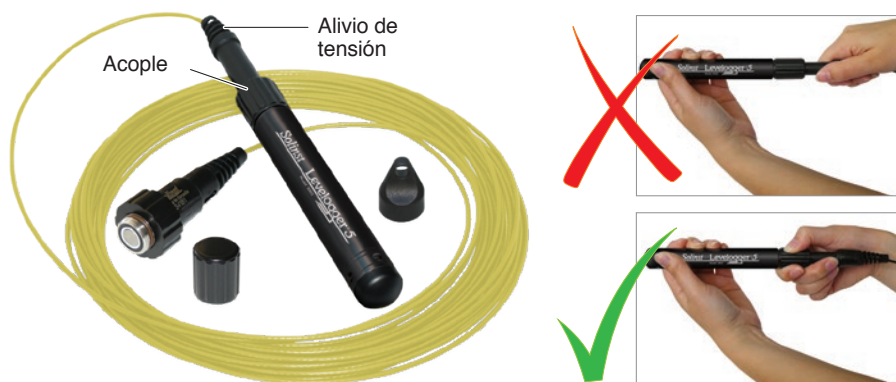
Figura 10-14 Forma correcta de retirar un cable de lectura directa de un Levelogger
