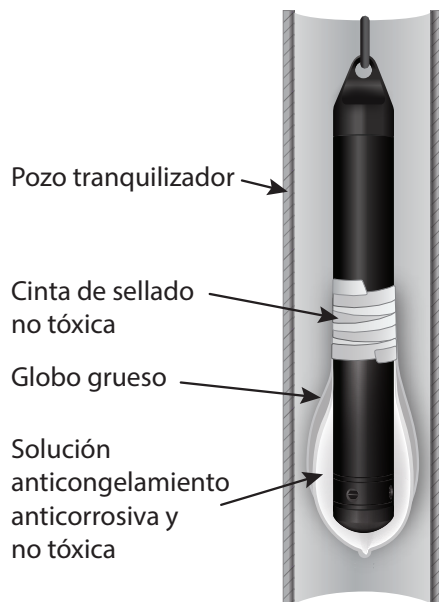
Figura 10-22 Instalación en líquido en congelamiento
