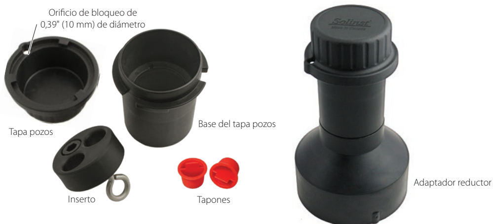
Figura 10-15 Conjunto de tapa pozos del modelo 3001 (N.º 110099) Hay un adaptador reductor para instalar Leveloggers en pozos de 4". (N.º 110235)
