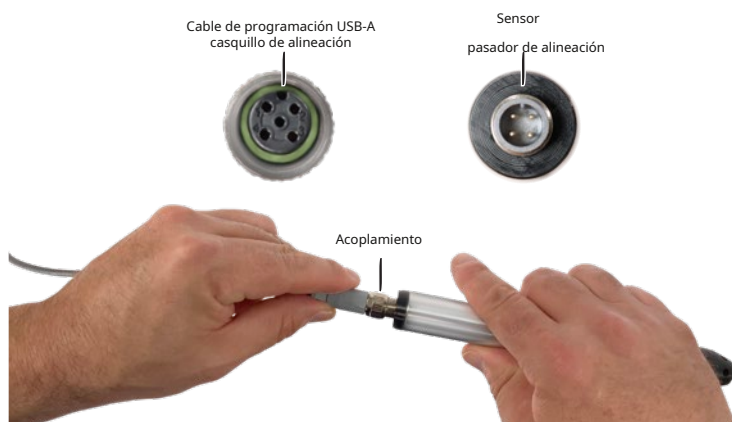
Conexión del sensor al cable de programación USB-A
