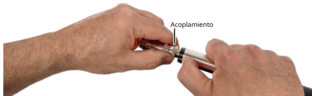
Conexión del sensor al cable de comunicación/ventilación
