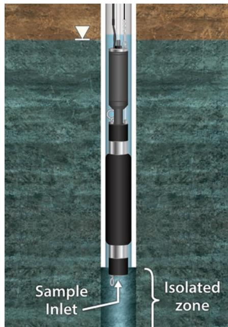
Se puede utilizar un empacador modelo 800M para aislar la zona de muestreo y reducir los volúmenes de purga.
